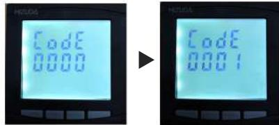
2. กด ▶ เลื่อนบันทัดแบบสุดไปที่ InPF และกด ← ไปบันทัดที่ 2 เลือกไปที่ CT(เพื่อตั้งค่าCT) กด ▶ เลื่อนไปที่ CF และกด ← เมื่อเลือก
