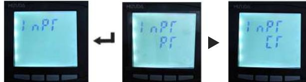
3. กดบันทัดที่ 3 กำหนดค่าCT แบบเป็นอัตราส่วน เช่น ถ้าใช้ CT250/5 ให้อ่าน 250 หารด้วย 5 ได้ = 50 ใส่ค่า 50 โดยกด ▶ เมื่อเลือกตัวเลข และกด ← เมื่อเลือกตัวเลขแล้วลงมาในตัวชี้ หลังจากป้อนค่าที่ต้องการให้กดปุ่ม Menu 2ครั้ง จะขึ้นหน้าจอตามว่าบันทัดไหน ก็กด ← จะเป็นการบันทึกข้อมูล
