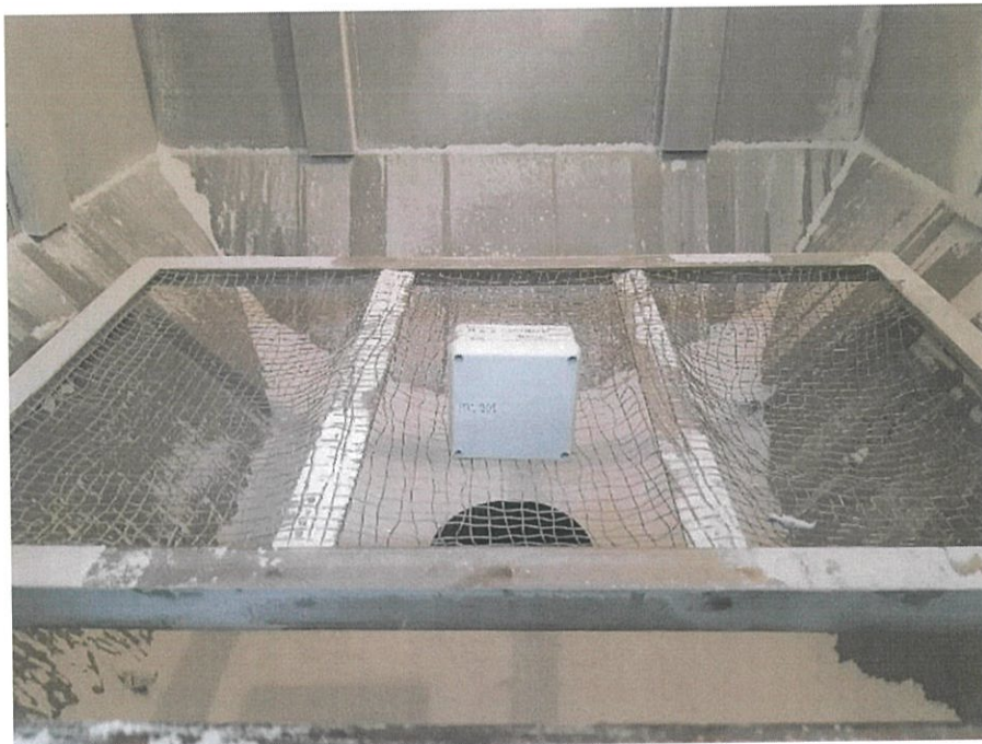
Photo No.4 : IP5X Dust test
