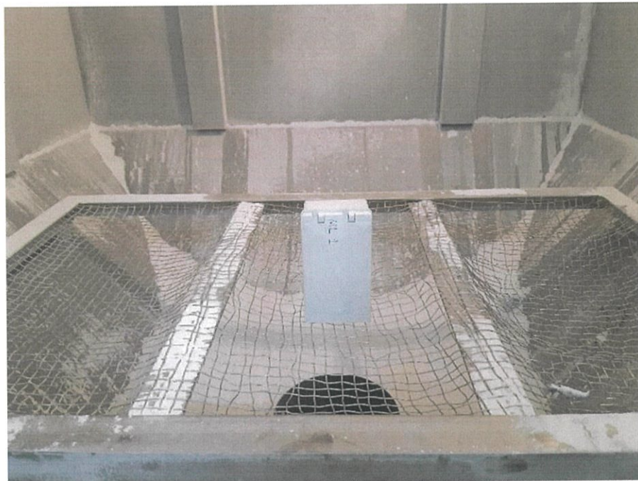
Photo No.4 : IP5X Dust test
